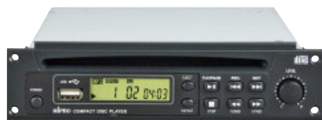
CDM-2 Professioneller CD / USB-Player Medien CD (Audio, MP3), USB Digitalfilter 8 bit Klirrfaktor < 0,1 % Rauschabstand > 80 dB Übertragungsbereich 10Hz - 20kHz (1kHz) WOW / Flatter Unter messbarer Grenze Abmessungen (BxHxT) 160 x 68 x 100 mm Gewicht Ca. 900 g
