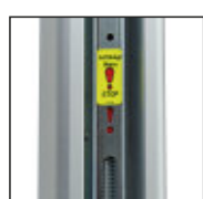
Anzeige bei Erreichen des maximalen Spannweges.
