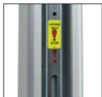
Anzeige bei Erreichen des maximalen Spannweges.
