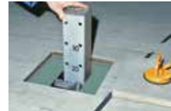
Ausfahren der Versenkrecksäule
