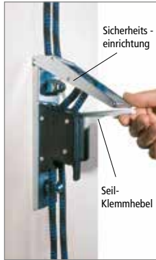
Öffnen des Seil-Klemmhebels für Seilarretierung nur bei entlastetem Seil möglich.
